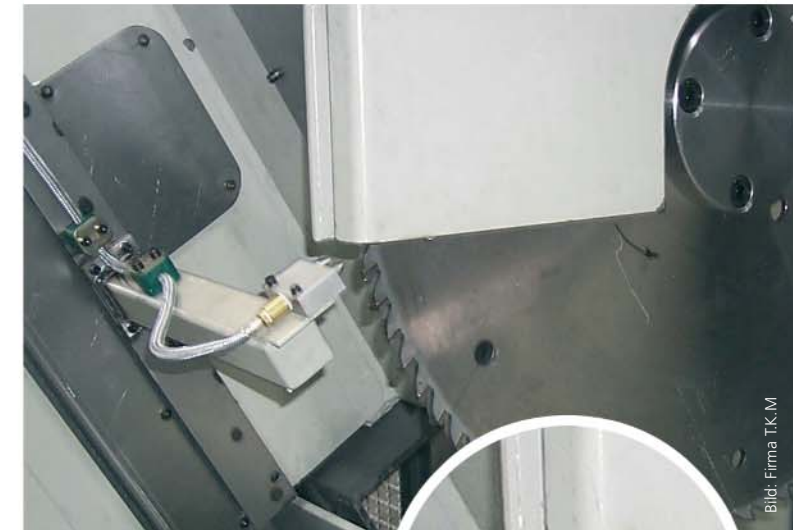
Äußere MMS-Zufuhr beim Sägen
